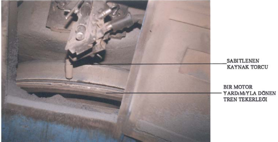
Resim 1.1: Tren tekerleğinin MIG – mag yöntemi ile otomatik olarak kaynak yapılması
